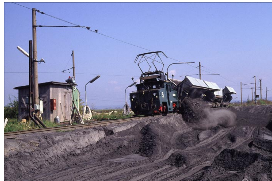
PreussenElektra, Wölfersheim: Entleeren eines Asche-Zuges mit Lok 5 an der Halde, 14. September 1990. (Andreas Christopher)
